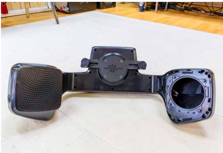
Als OEM-Lieferant für Automobilindustrie und Luftfahrt beschäftigt sich Gerkinsmeyer schwerpunktmäßig mit dem Thema „Großer Klang auf kleinem Raum“. Kompakte Elektronik und geringe Einbautiefen sind dabei Pflicht. Unten rechts sehen Sie einen Teil eines Motorrad-Armaturenbretts, der als Klangkörper dient, unten links seine Papier-Schaumstoff-Sandwichmembranen in verschiedenen Stärken.
